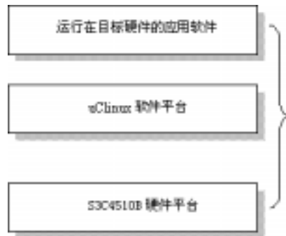
图 7.8 基于 uClinux 嵌入式系统框图
