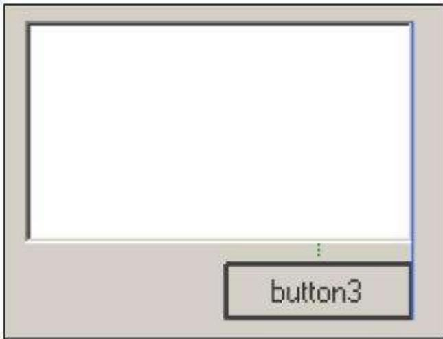
图 73 用于对齐界面元素的彩色线条(蓝色实线和绿色虚线)
