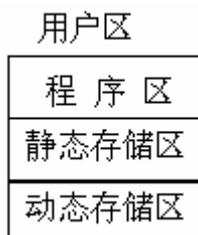
全局变量全部存放在静态存储区，在程序开始执行时给全局变量分配存储区，程序行完毕就释放。在程序执行过程中它们占据固定的存储单元，而不动态地进行分配和释放；
