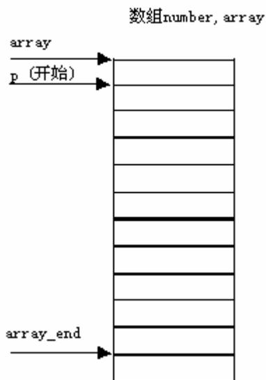
4) 函数 `max_min_value` 的形参 `array` 可以改为指针变量类型。实参也可以不用数组名, 而用指针变量传递地址。
