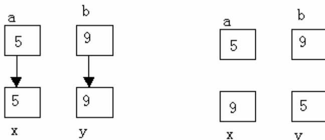
**【例 10.4】** 请注意, 不能企图通过改变指针形参的值而使指针实参的值改变。
