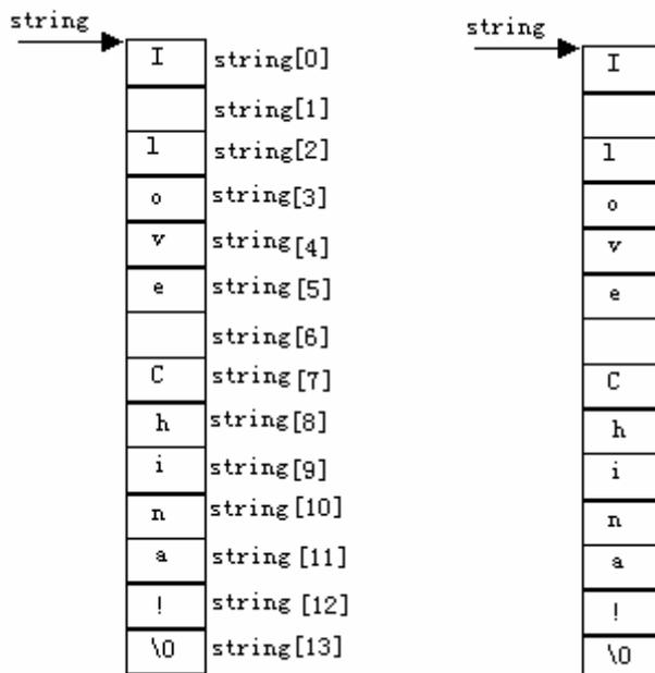
2) 用字符串指针指向一个字符串。
