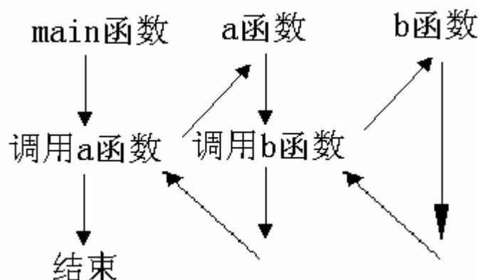
图表示了两层嵌套的情形。其执行过程是: 执行 main 函数中调用 a 函数的语句时, 即转去执行 a 函数, 在 a 函数中调用 b 函数时, 又转去执行 b 函数, b 函数执行完毕返回 a 函数的断点继续执行, a 函数执行完毕返回 main 函数的断点继续执行。
