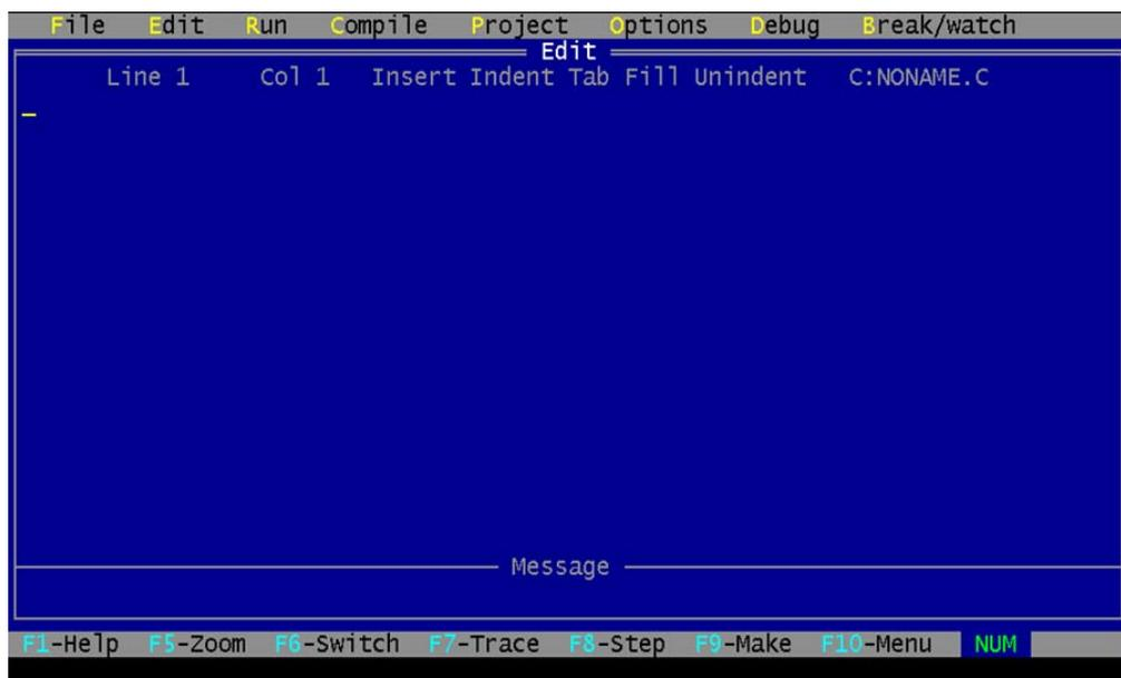
其中顶上一行为 Turbo C 2.0 主菜单，中间窗口为编辑区，接下来是信息窗口，最底下一行为参考行。这四个窗口构成了 Turbo C 2.0 的主屏幕，以后的编程、编译、调试以及运行都将在这个主屏幕中进行。
