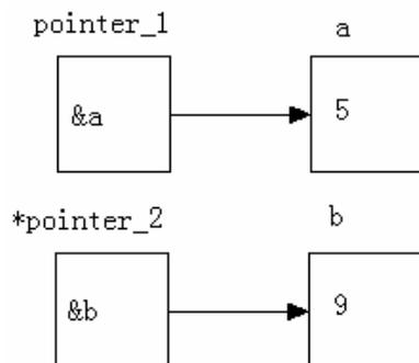
接着执行 if 语句，由于  $a < b$ ，因此执行 swap 函数。注意实参 pointer\_1 和 pointer\_2 是指针变量，在函数调用时，将实参变量的值传递给形参变量。采取的依然是“值传递”方式。因此虚实结合后形参 p1 的值为 &a，p2 的值为 &b。这时 p1 和 pointer\_1 指向变量 a，p2 和 pointer\_2 指向变量 b。
